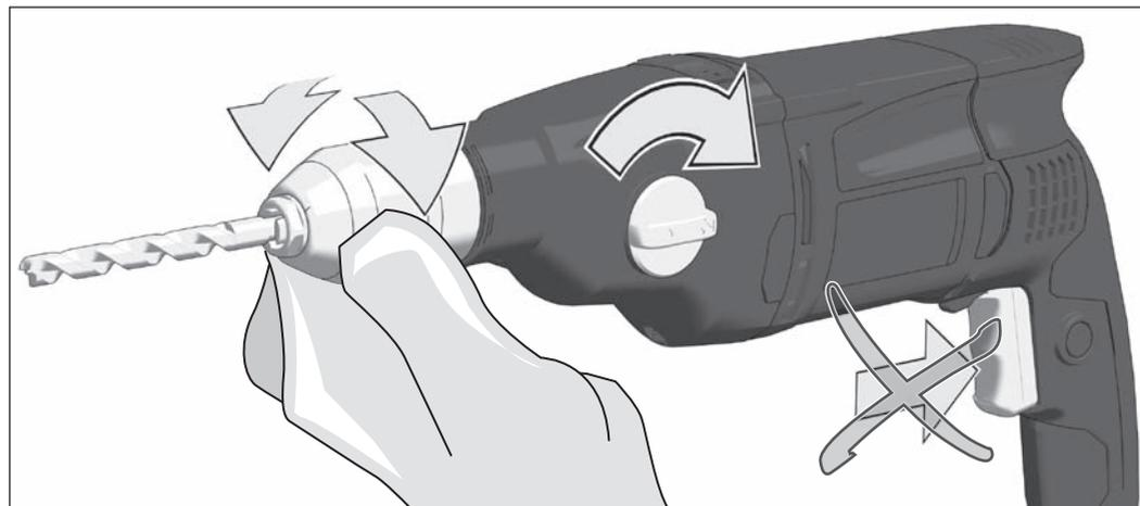
Den Gangschalter niemals bei eingeschalteter Maschine, sondern nur im Stillstand betätigen.
