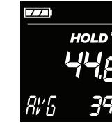
3. Laat de drukschakelaar los. HOLD verschijnt totdat de weergave na 7 seconden dooft.
