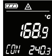
2. Op het display wordt de waarde van de secundaire weergave voortdurend geactualiseerd totdat de temperatuur van de sonde overeenstemt met de temperatuur van het te meten voorwerp of de te meten vloeistof. Het display schakelt na 20 minuten uit.
