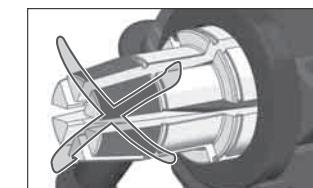
Draai de zes expandersegmenten met de klok mee. De kop kan vrij worden gedraaid.
