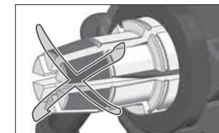
Girar los seis segmentos del extensor en el sentido de las agujas del reloj. El cabezal girará libremente.
