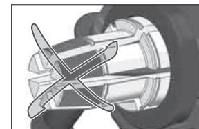
Поворачивать шесть сегментов расширителя по часовой стрелке. Головка должна вращаться свободно.
