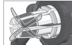
Die sechs Expandersegmente im Uhrzeigersinn drehen. Der Kopf lässt sich frei drehen. Der Kopf darf sich nicht gegen den Uhrzeigersinn drehen lassen.
