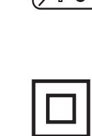
Classe de protection II, outil électrique au niveau duquel la protection contre la foudre ne dépend pas uniquement de l'isolation de base et au niveau duquel des mesures de protection ultérieures ont été prises, telles que la double isolation ou l'isolation augmentée.
